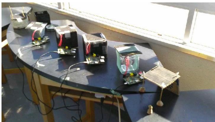
図 6 複数台のラズベリーパイと気温センサを用いた生徒自作の計測機器
