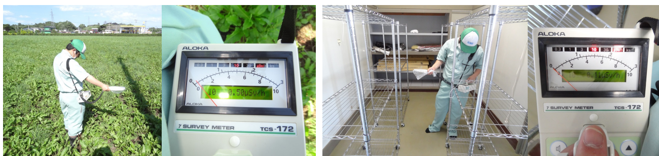
図3 ガイガーカウンターによる放射線量調査 牧草地（左）と植物工場内（右）の比較を行う
