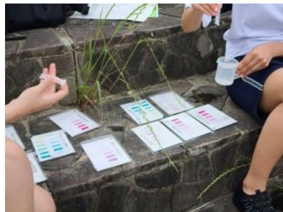
図7 採水した河川水のサンプルを陸上に持っ ていき、簡易水質検査試薬を用いて、水質試験を実施している。
