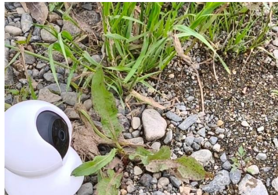
図8 河原に設置したネットワークカメラ。モバイルバッテリーで駆動し、Cloud Wifi を用いて配信を行った。
