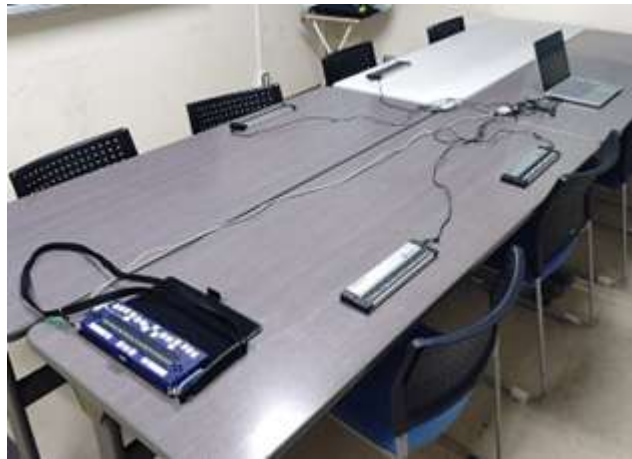
図1 整備した点字共同作業の仕組み (更新後 GIGA Windows 端末使用)
