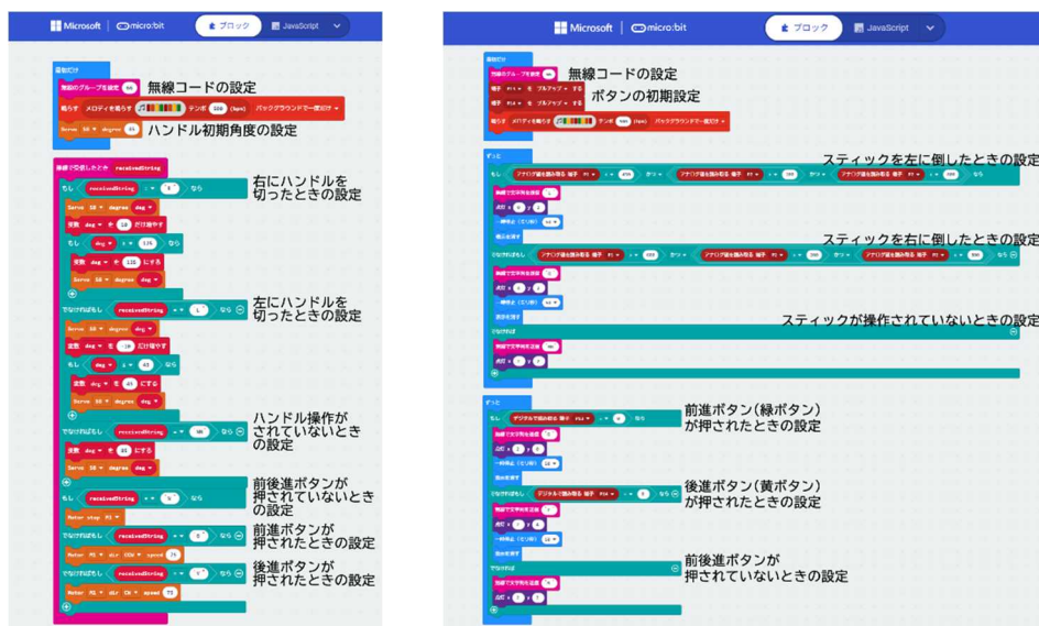
図6 制御用コードの例（左：車体用 / 右：コントローラー用）
