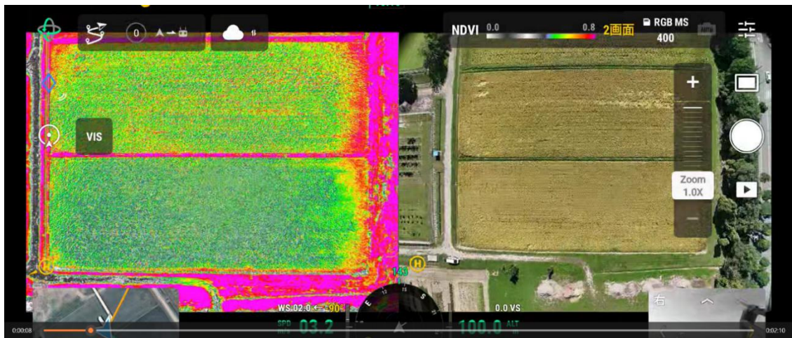
図1 Mavic 3 Multispectral (Mavic 3M) によるリアルタイム解析画像 (2026年8月北海道岩見技術農業高校水稻圃場)
