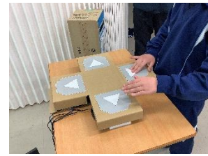
図6 スイッチを使用した自作十字キー
