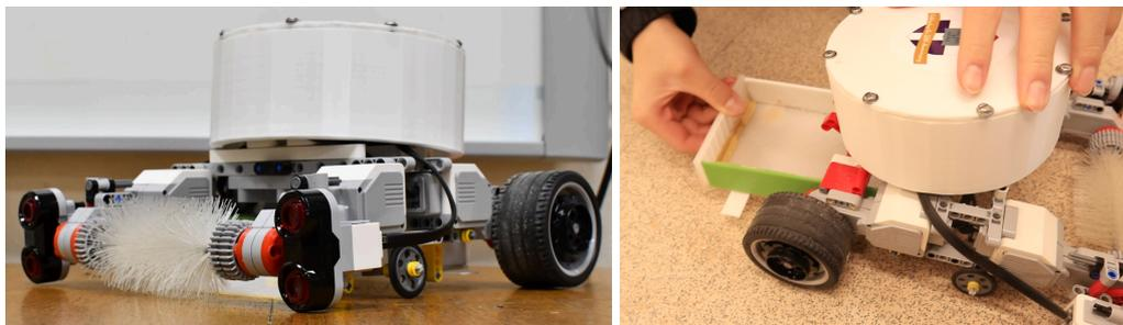
写真7. ブラシをモーターで回しゴミを集め、超音波センサーで障害物を見る 写真8. 3Dプリンターで着脱可能なゴミ受け皿を作った
