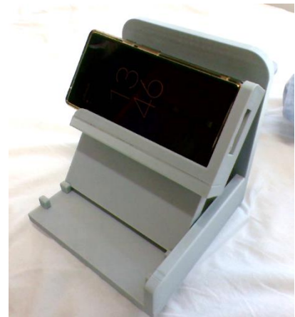
図 10 ベッド上でスマートフォンを利用するための自助具
