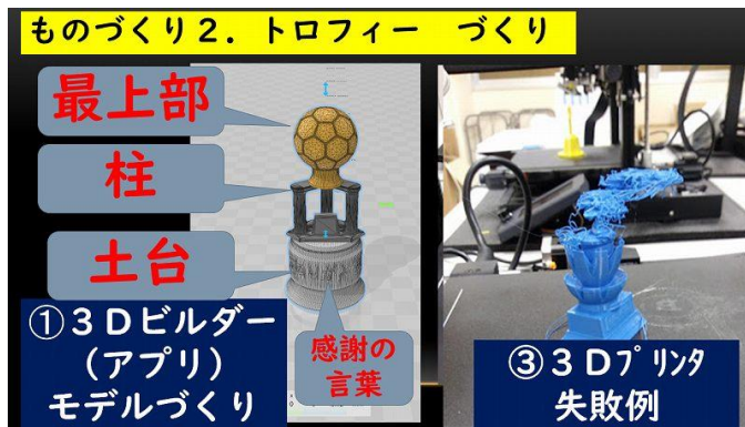
【図4 トロフィーのモデル制作 右側写真は失敗例】
