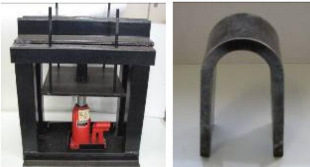
写真6-4 JIS溶接検定用曲げ試験機と曲げ試験片
