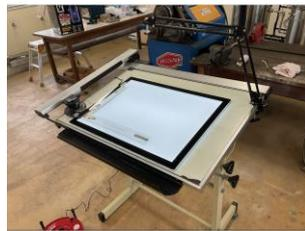
写真 2 試作品 (LED トレース台)
