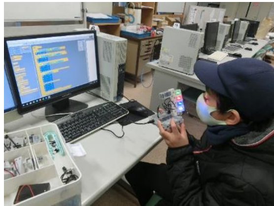
図7 音を感知して光るLED（音量測定器）
