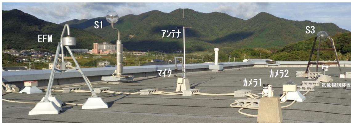
図1 屋上に設置した観測装置
