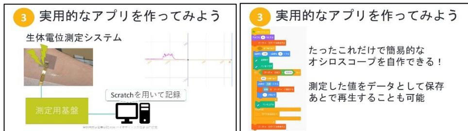
資料 2. Scratch による電位測定プログラム説明スライドの一部
