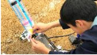
プログラムした Micro-bit で発射角度を測る。
